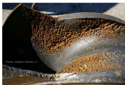
Fig. 5.10. Cavitation damage on an impeller
