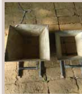
Формы для изготовления блоков полного и половинного размера
