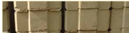
ГРУНТОВЫЙ НЕОБОЖЖЁННЫЙ ПРЕССОВАННЫЙ БЛОК, ИЗГОТОВЛЕННЫЙ ПРИ ПОМОЩИ ГИДРАВЛИЧЕСКИХ МАШИН
