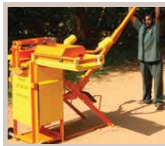
РУЧНАЯ МАШИНА ДЛЯ ПРОИЗВОДСТВА ГРУНТОВЫХ НЕОБОЖЖЁННЫХ КИРПИЧЕЙ/ БЛОКОВ
