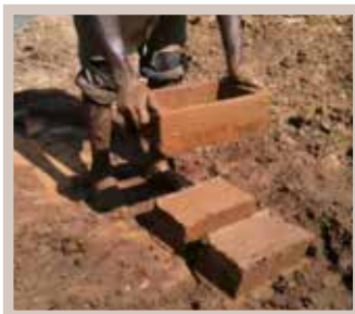
ДЕРЕВЯННАЯ ФОРМА, ИСПОЛЬЗУЕМАЯ ДЛЯ ПРОИЗВОДСТВА СЫРЦОВОГО КИРПИЧА
