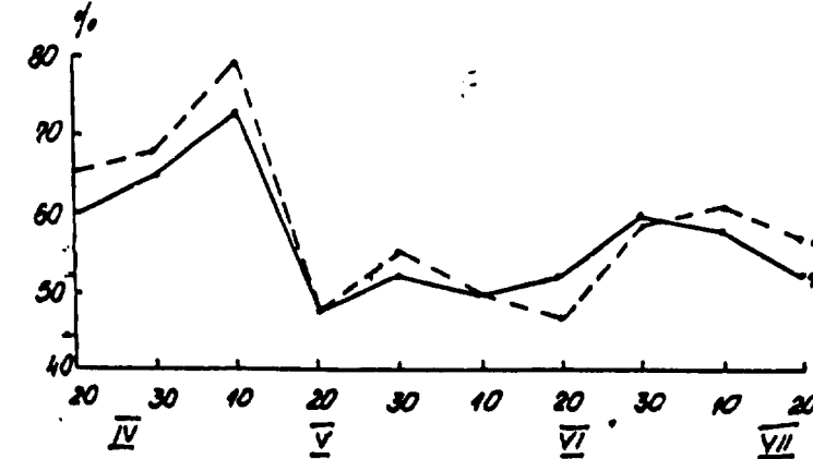
fig.2 Les conditions microclimatiques en serre couvertes de PE - ordinaire (1) et de la PE polysvatan (2) pendant 1987. a) radiation solaire; b) t^{\circ} de l'air; c) t^{\circ} maximale; d) t^{\circ} minimale; e) t^{\circ} du sol; f - humidite relative de l'air
