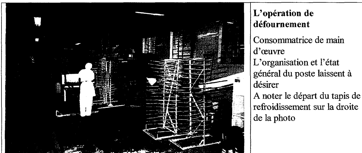
Figure n° 28: Le poste de défournement
