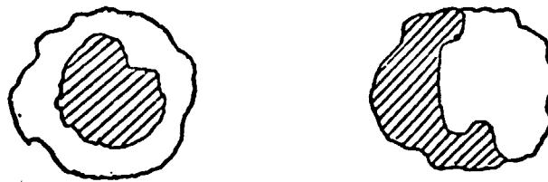
Querschnittstruktur latent kräuselfähiger Bikomponentenfasern
