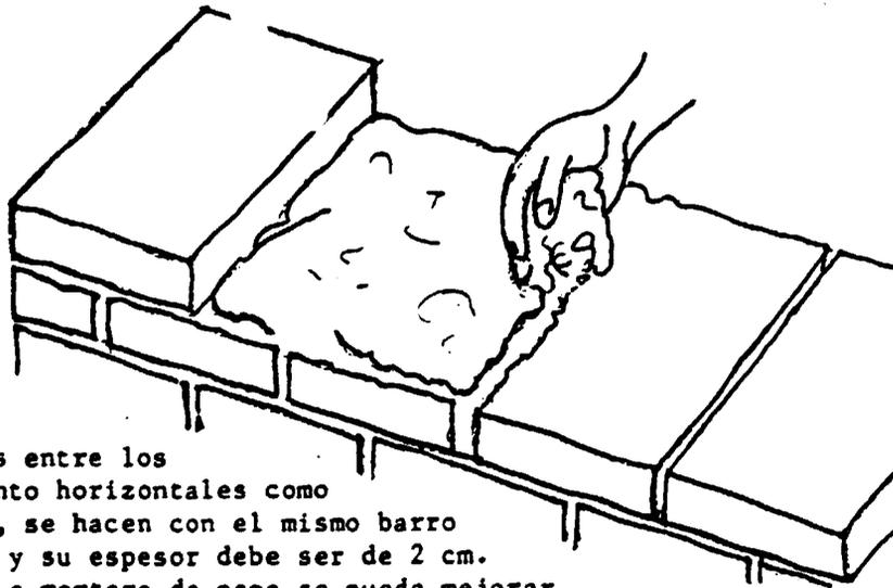
Las uniones entre los adobes, tanto horizontales como verticales, se hacen con el mismo barro del adobe, y su espesor debe ser de 2 cm. Esta unión o mortero de pega se puede mejorar agregándole cemento (1 a 2 partes para 20 partes de tierra), mezclándolo bien en seco antes de añadirle el agua.
