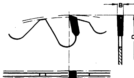
Figure 7. Dent droite avec limiteur de copeaux
