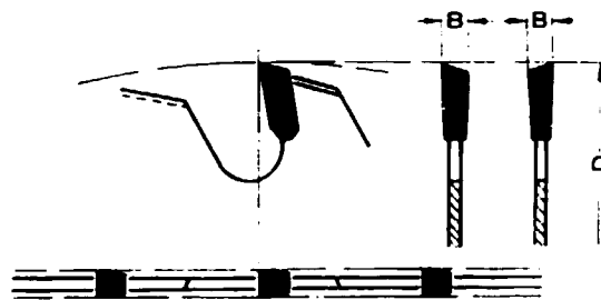
Figure 6. Dent à arêtes inclinées alternativement
