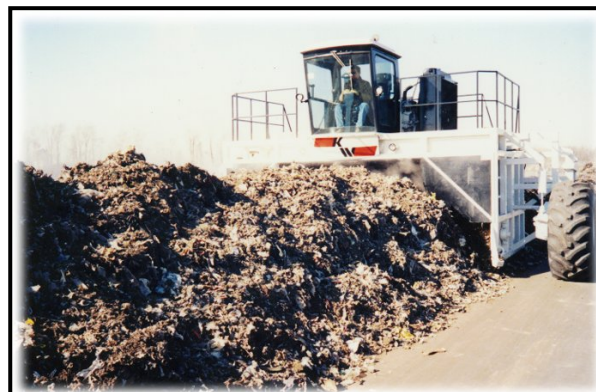
Figura 31. Volteador de las pilas de compost
