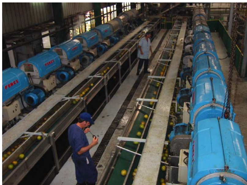
Figura 17. Línea de extractores de jugos cítricos
