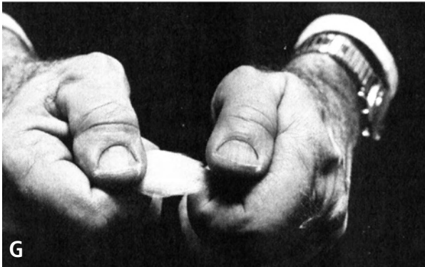
Figure 7. Méthode du « pulling ». Préparation de la barbe de fibre, étapes finales. (courtoisie USDA)
