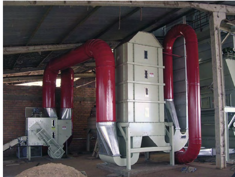
Figure 32. Certains séchoirs sans chicane génèrent peu de pression statique. (Cliché J.-L. Chanselme © COTIMES)
