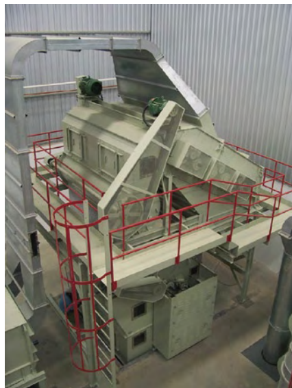
Figure 34. Dispositifs de sécurité autour d'une machine.
