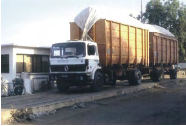
Figure 3. Attelage de transport du coton-graine de type poly-benne. (Cliché © Cirad)
