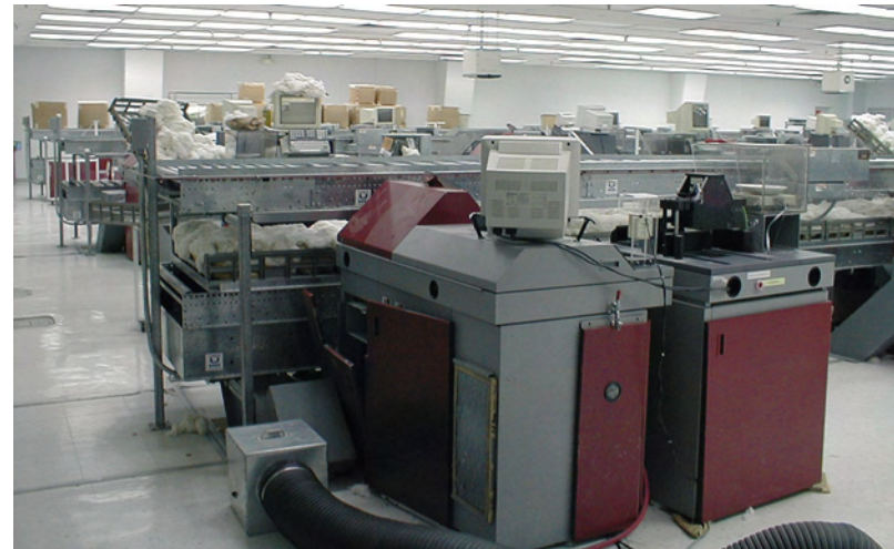
Figure 8. Laboratoire de classement à Dumas (Arkansas, Etats-Unis d'Amérique). On notera au plafond les dispositifs de conditionnement d'air et les deux boîtes d'enregistrement indépendant des caractéristiques de l'air ambiant. (Cliché G. Gawrysiak © Cirad)
