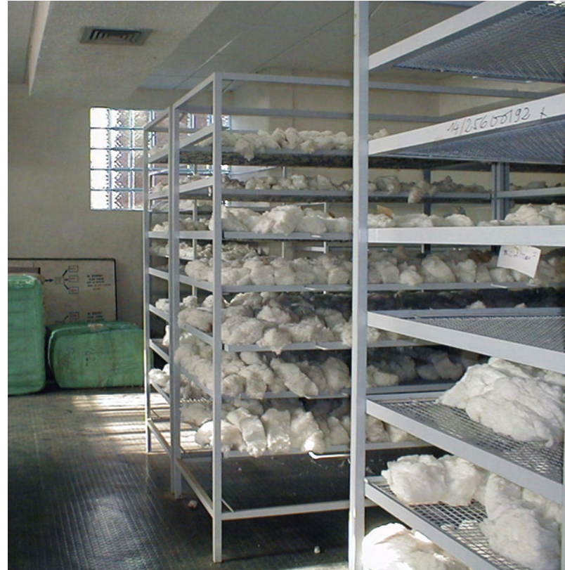
Figure 4. Exemple d'étagères de stockage des échantillons avant analyse. On notera les bouches d'arrivée d'air conditionné au plafond. Sonapra, Parakou, Bénin (Cliché B. Bachelier © Cirad).
