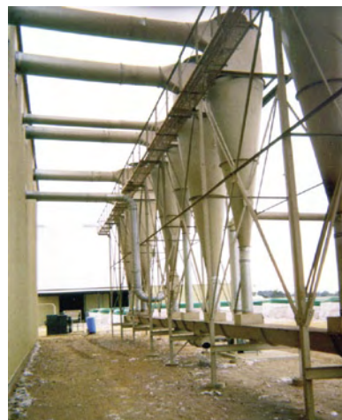
Figure 19. Cyclones à haute efficacité 1D-3D. (Cliché J.-L. Chanselme © COTIMES)
