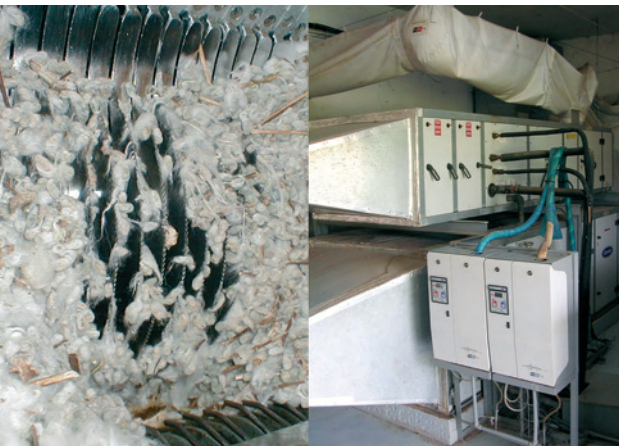
Figure 10. Exemples d'équipements critiques (de gauche à droite) : scies et barreaux d'égreneuse, (cliché B. Bachelier © CIRAD) groupe froid.
