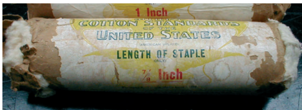
Figure 8. Exemple de non conformité : matière de référence périmée. (cliché B. Bachelier © Cirad)
