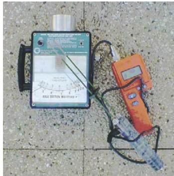
Figure 8. Humidimètres pour la mesure de l'humidité des cotons.
