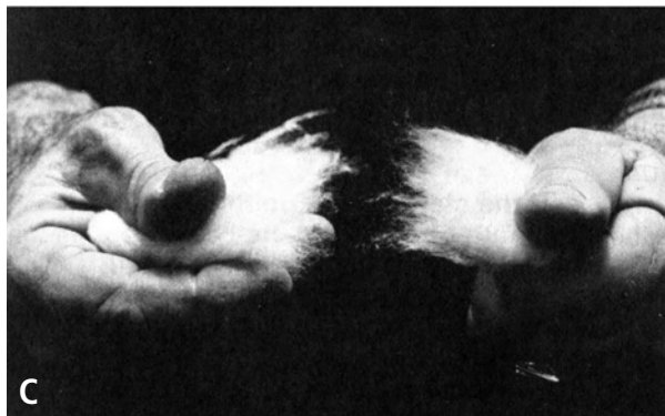
Figure 6. Méthode du « pulling ». Préparation de la barbe de fibre, premières étapes. (courtoisie USDA)
