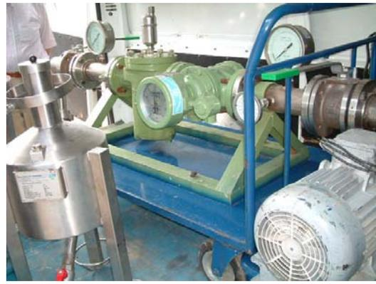
El equipamiento de la estación móvil de aforo de tanques del CNICA
