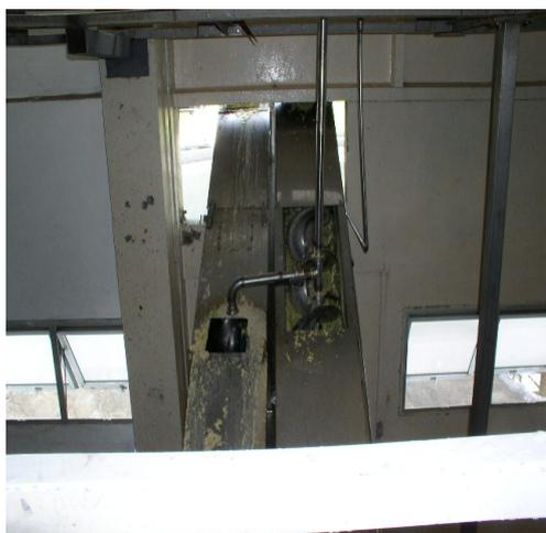
*Figura 19. Recubrimiento del tornillo sinfín*
