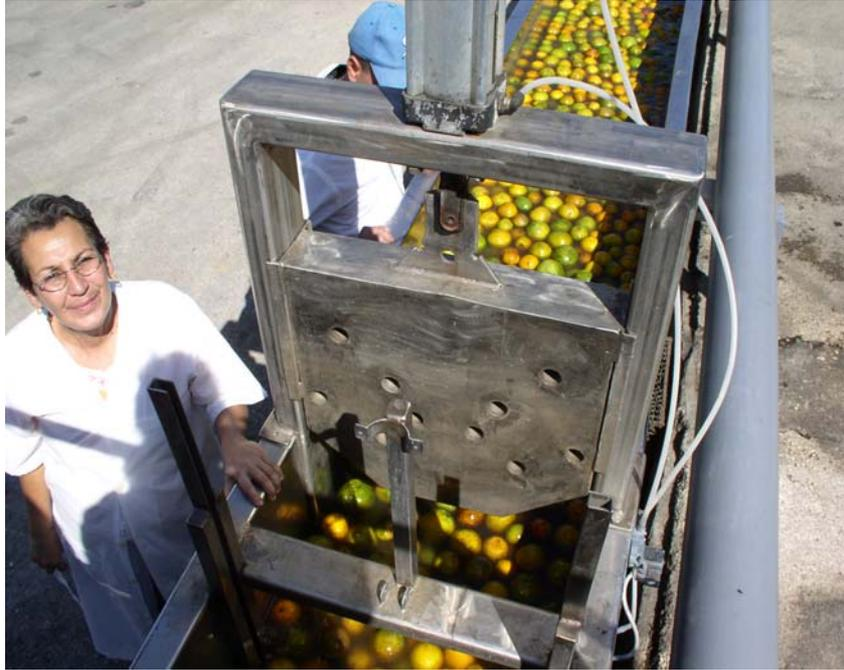
*Figura 14. Dispositivo para regular el agua destinada al lavado de la fruta*
