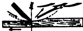
FIGURE IX. COMMENT TRAVAILLE UN OUTIL ROTATIF
