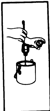
FIGURE II. DETERMINATION DE LA VISCOSITE AVEC UNE COUPE FORD
