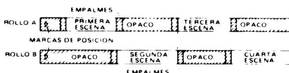
Figura 41. Montaje de los rollos A y B en película de 16 mm
