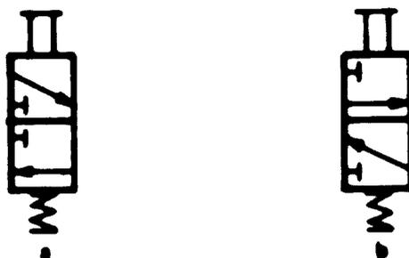
Figure No 58 : Symboles utilisables pour le distributeur à deux positions et à trois orifices
