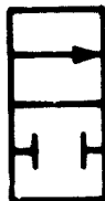
Figura 46. Símbolo básico de la válvula de dos posiciones y dos orificios de la figura 45
