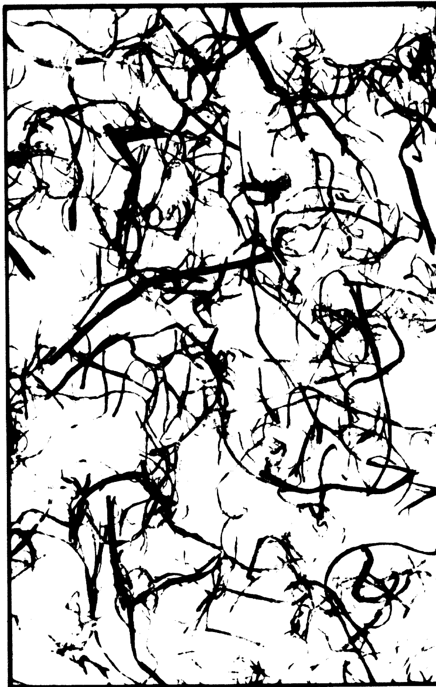
Figure 3 : Aspect de la fraction de fibres passant à travers les tamis à mailles carrées, les côtés étant de 1x1 mm et de 2x2 mm - agrandi 3,5 fois
