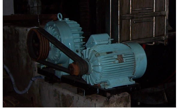
চিত্র: ৬ সংস্কারকৃত ড্রামের সঞ্চালন ব্যবস্থা।
