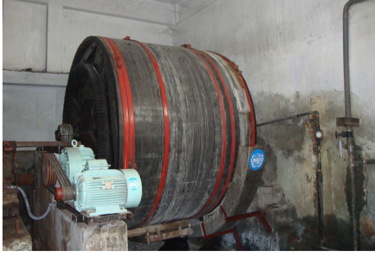
চিত্র ৭ : একটি স্বয়ংসম্পূর্ণ উন্নত ড্রাম যার সাথে পানি পরিমাপের জন্য একটি মিটার সংযুক্ত আছে ।
