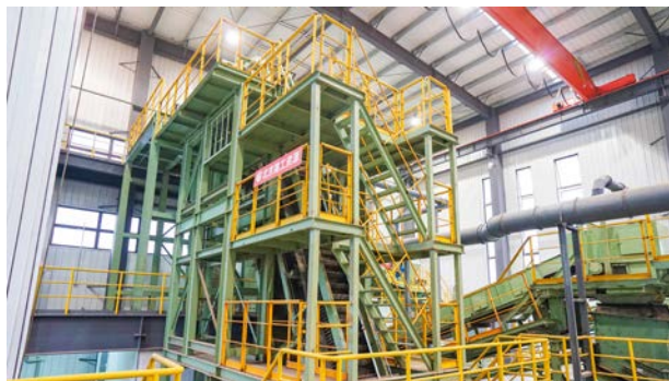
极有限空间内、立体式、紧凑化装修垃圾 综合处置工艺
