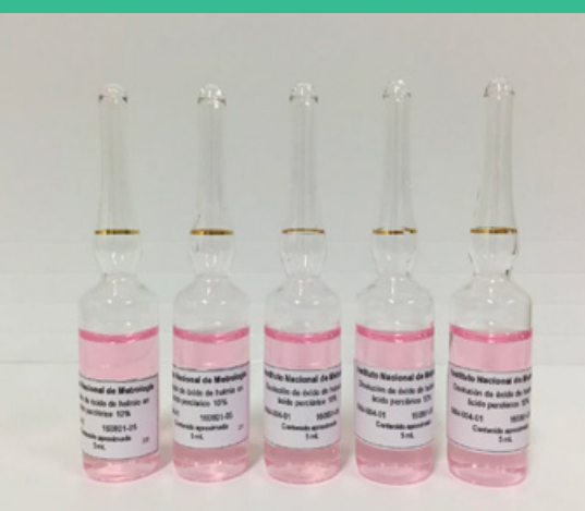
Oxido de Holmio para calibración de espectrofotómetros
