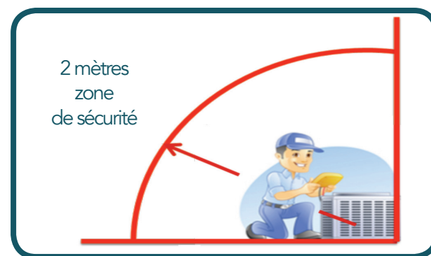
Figure 8 Zone inflammable temporaire pour les petits appareils
